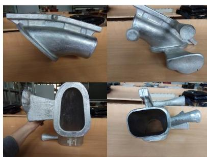
Рис. 3. Готовая отливка «Патрубок» из сплава АК9ч с элементами литниково-питающей системы
