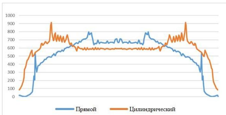
Рис. 3 Контактные напряжения в ролике
