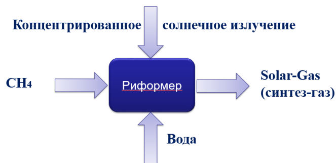
Рис. 1. Принципиальная схема парового риформинга метана
