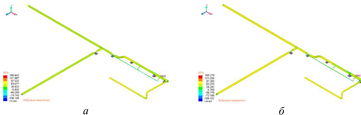
Рис. 2. НДС трубной обвязки при просадке опор камеры пуска
