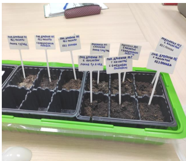
Рис. 2. Исследование на разложение в почве
