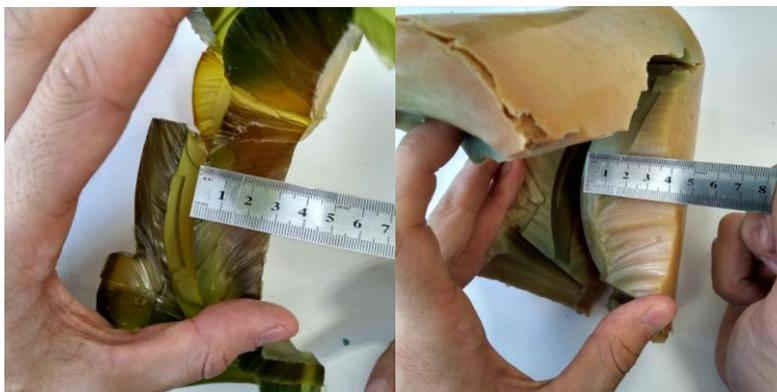
Толщина стенок вкладышей пресс-форм:
