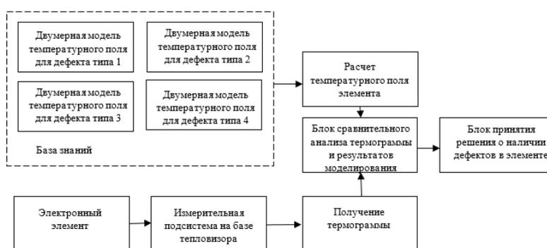
Рис. 1. Контроль технического состояния электронных приборов по тепловому полю
