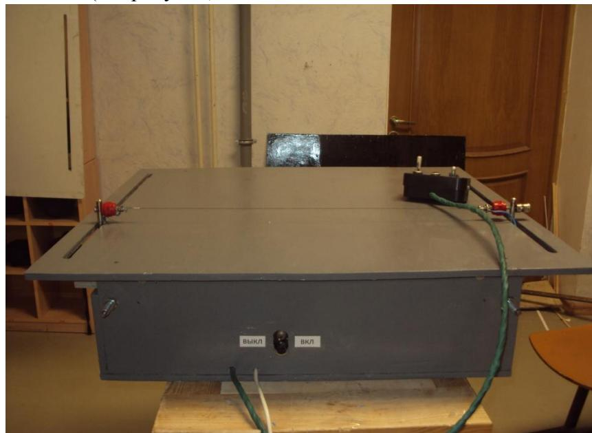
Станок для резки утеплителя
