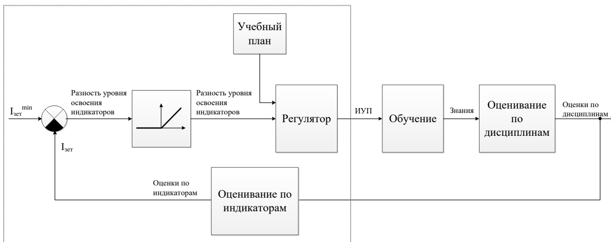
Структурная схема проектируемой автоматизированной системы управления процессом обучения с обратной связью
