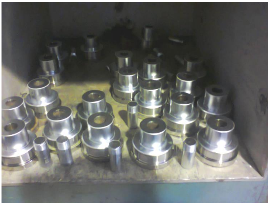
Внешний вид образцов с нанесёнными хром-алмазными покрытиями
