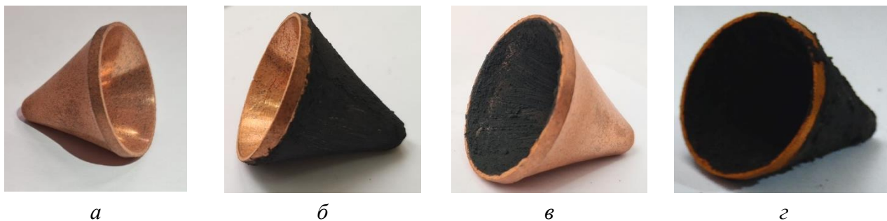
Рис. 1. Внешний вид кумулятивных облицовок: а – без покрытия; б, в, з – с покрытием
