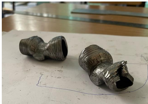
Рис. 3. Трубчатые болты после проведенного испытания
