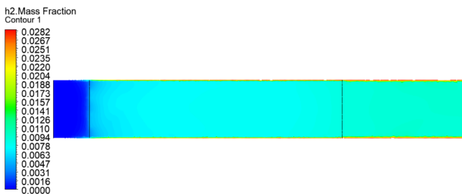
Рис. 3. Контур распространения массовой доли водорода с катализаторами, заданными пористой зоной
