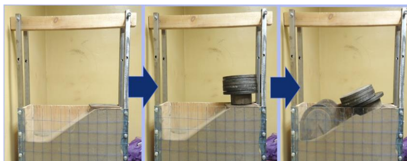
Рис. 2. Процесс нагружения и разрушения неукрепленного откоса
